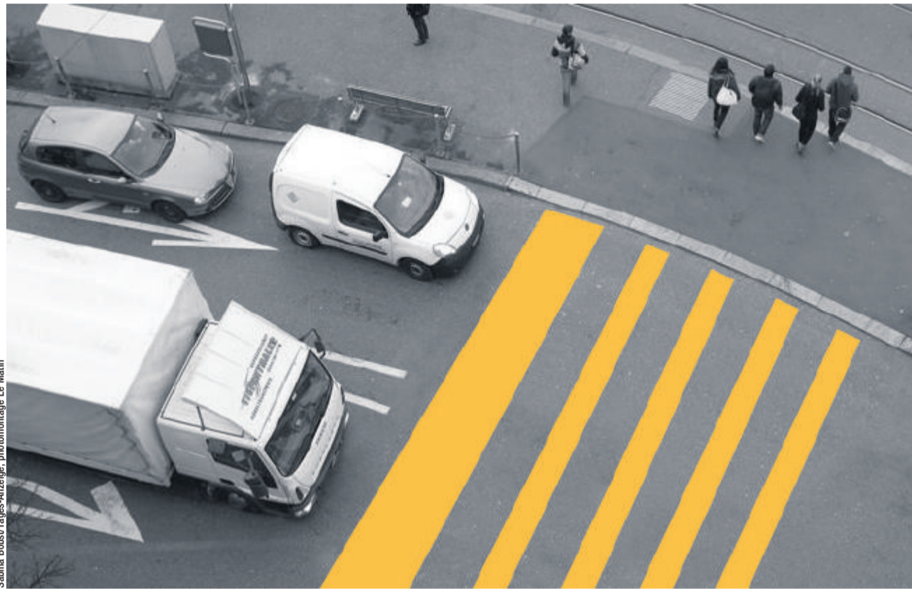
L'une des propositions, pour améliorer la sécurité des piétons, est de disposer les bandes jaunes des passages perpendiculairement aux véhicules, dont la première plus large, pour donner aux automobilistes l'impression qu'il s'agit d'un stop. Photomontage
